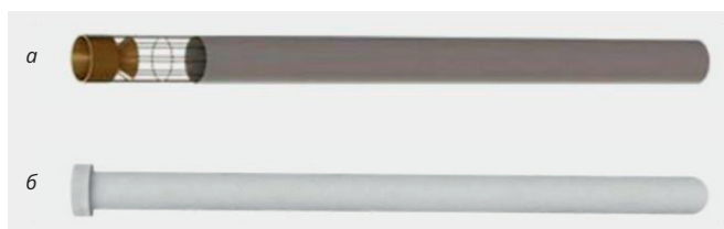
Рис. 1. Общий вид фильтрующих элементов: а – гибкий фильтрующий элемент на металлическом каркасе применяется в рукавных фильтрах; б – жесткий керамический волокнистый фильтрующий элемент ФГВК применяется в ФКИ
