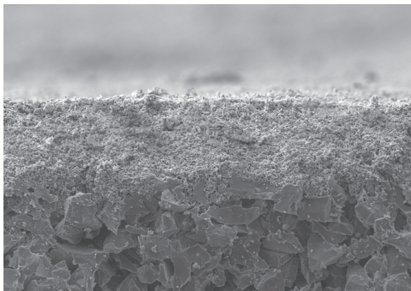
Рис. 2. Микроструктура образца пористой проницаемой керамики с мембранным покрытием. \times 500
